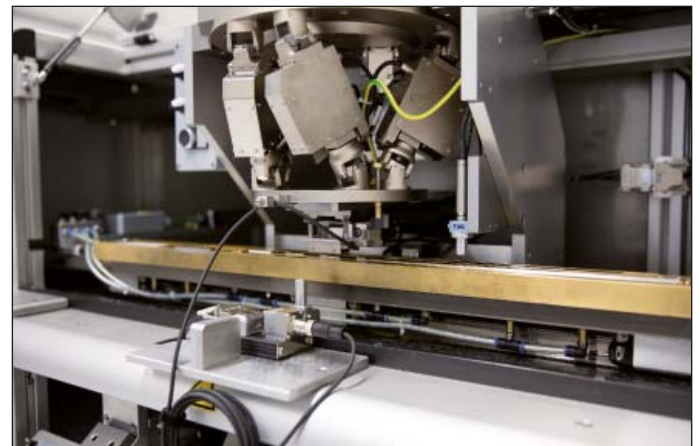
Abbildung 10: Auf einem speziellen Messplatz wird bei jedem offenen Längenmessgerät die Interpolationsabweichung durch Vermessen des Abtastkopfes ermittelt.
