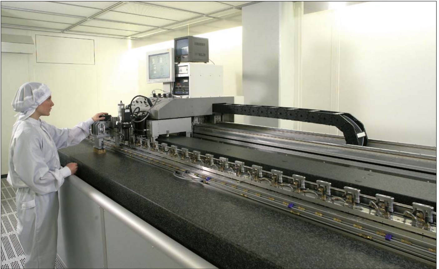
Abbildung 9: Für jeden Maßstab eines offenen Längenmessgeräts ermittelt HEIDENHAIN mit Hilfe einer speziellen Messmaschine die Basisabweichung in einem definierten Intervall.
